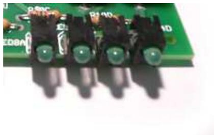
Sul connettore di colore verde ci sono le uscite supplementari, come si puo' vedere dalle figure sotto riportate il BMS dispone di un circuito optoisolato il quale è di norma **aperto** Questo cambia di stato a **chiuso** solo quando tutte le celle collegate sono completamente cariche e bilanciate.
